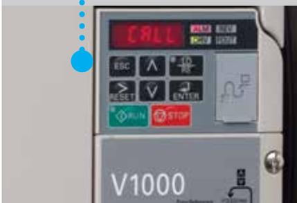
Verändert die Drehgeschwindigkeit des Rührwerks von 7 bis 70 Hertz. Mit Hilfe der SPS und dem Wechselrichter gewährleistet die neue Smarty TTI die der Mischung, den Zutaten, deren Ausgewogenheit und der produzierten Menge entsprechende Zubereitung ausgezeichneter Eiscreme.
