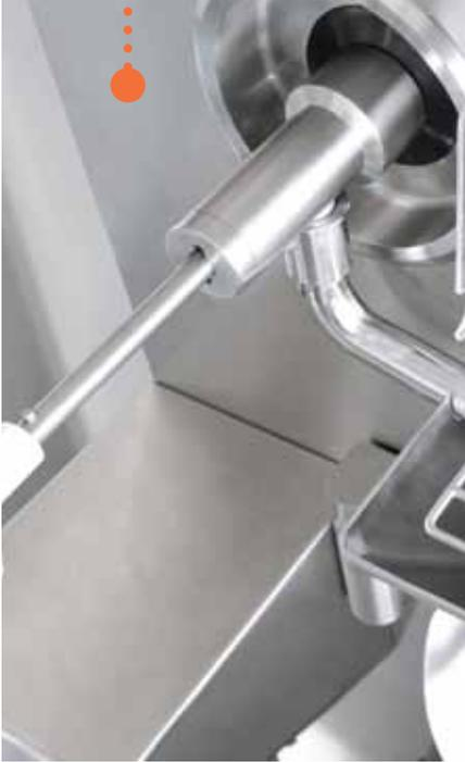
允许混合物直接到达批量冷冻缸的外部旋塞，加热系统与冷却系统完全分离。
