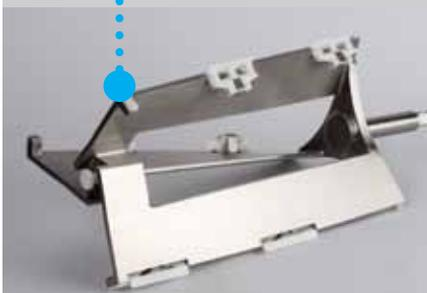
特殊设计的螺旋面搅拌器配备了会聚角可变叶片和高性能刮片，要达到完美的批量冷冻效果，需将冰淇淋均匀且系统地涂抹在整个冷冻缸表面，这样可避免叶片上或冷冻缸中央的冰淇淋出现过度冷冻现象。
