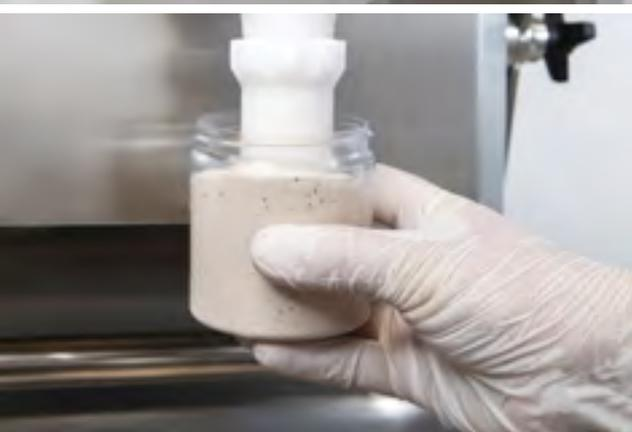
Mit den drei verschiedenen Dosiergeschwindigkeiten des **DOSY 3** haben Sie die volle Kontrolle über den Becherfüllprozess, vom Füllbereich bis zur manuellen oder halbautomatischen Füllgeschwindigkeit. Zum Beispiel: 20 Becher à 150 ml können in 1 Minute befüllt werden. Das Display des **DOSY 3** ermöglicht eine einfache Überprüfung der Anzahl der gefüllten Becher, wobei jeder Schuss für jeden Zylinder, die Anzahl der Zylinder und die Anzahl aller Becher gezählt werden.
