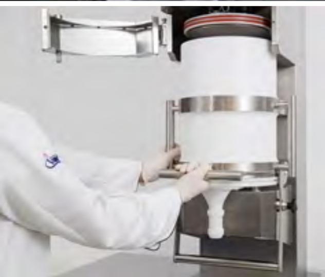
Das System sorgt für eine genaue **Dosiergeschwindigkeit**, entsprechend der jeweiligen Becherkapazität. Eine Besonderheit bei der Bedienung dieses Systems ist, dass es die Geschwindigkeit zu Beginn automatisch anpasst: zunächst schnell und gegen Ende langsam.
