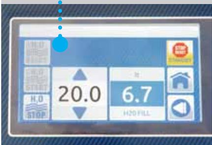
Mit automatischem Literzähler. Die in die Wanne abzufüllende Menge kann festgelegt werden.
