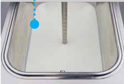
Kühlsystem zur Konservierung der Mischung mit Anti-Eis-System. Ein rechteckiger Einzelblock aus Edelstahl mit abgerundeten Ecken und geneigtem Boden, der das Abfließen auch besonders dickflüssiger Mischung durch den Hahn vereinfacht und beschleunigt.
